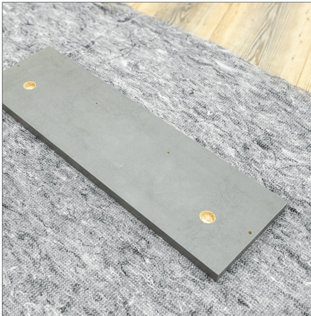
Verstellbare Einschlaghülse einschlagen Drive in adjustable drive-in sleeve
