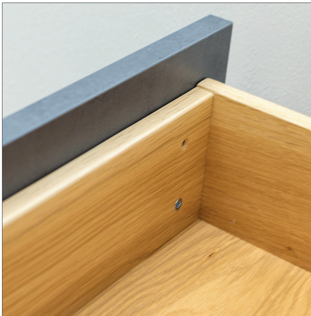
Verstellbare Einschlaghülse einschlagen Drive in adjustable drive-in sleeve
