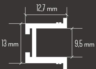
Korpusführungsschiene aus Kunststoff muss in das Aluminiumprofil eingeclipst werden (separat bestellen).
