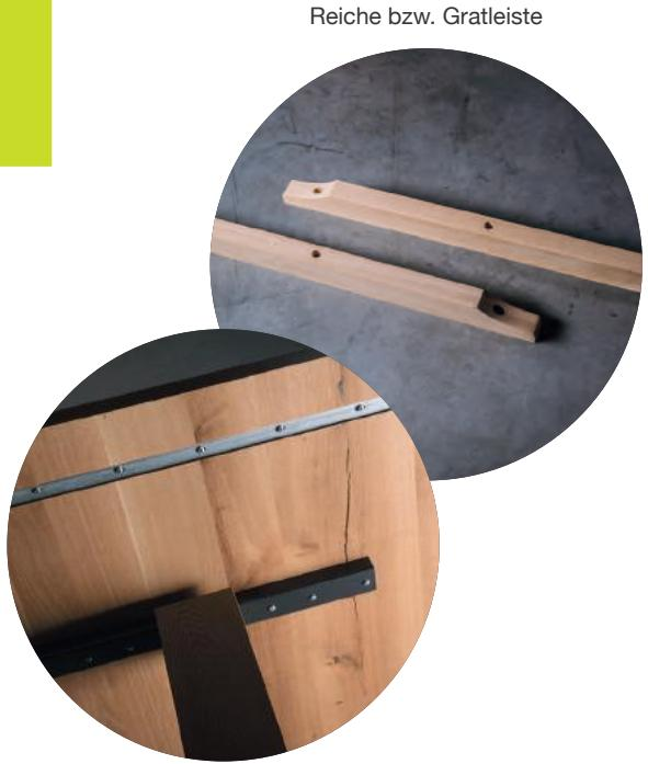
Beispiel: Wird eine Massivholzplatte auf ein Metallgestell montiert, muss durch eine Langlochbohrung sichergestellt werden, dass die Platte mehrere Millimeter arbeiten kann.
