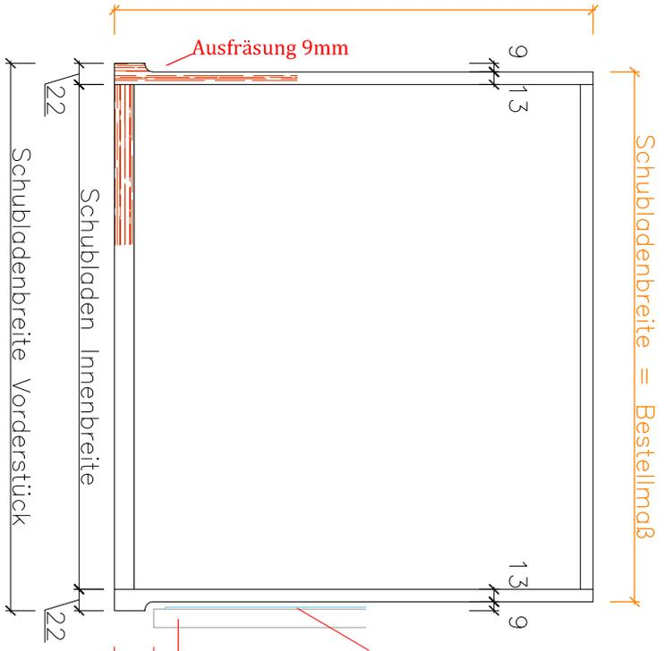
Führungsschiene ist um 12mm gegenüber der Standard Einstellung rückversetzt
