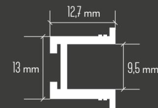
Korpusführungsschiene aus Kunststoff muss in das Aluminiumprofil eingeklipst werden (separat bestellen).
